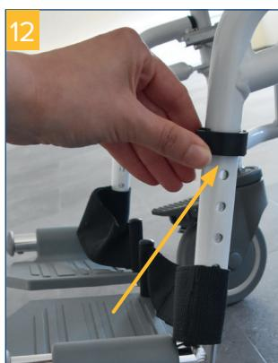
Ziehen Sie die Fußauflage leicht nach oben. Ziehen Sie den Clip heraus, und stecken Sie ihn an der gewünschten Position wieder hinein (**Bild 12**).
